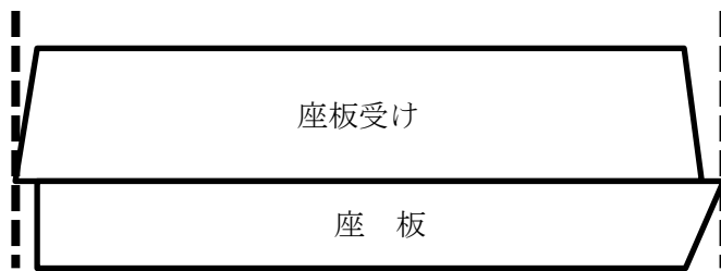
図7 座板と座板受けの大きさが合わずに重ねた状態
